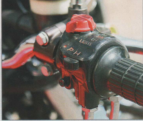
Der E-Starter (unterer Knopf) gehört wie selbstverständlich zu einer Vierzylinder-Honda. Einen Kickstarter gab's aber auch
