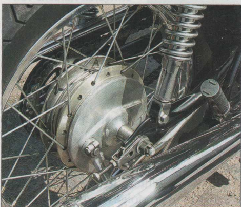
Stand der Technik: Simplextrommel im Hinterrad. Der Prospekt stellte stolz die „mechanische Innenbackenbremse“ heraus
