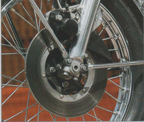
Bremstechnik anno 1974: Sattel vor dem Gabelrohr, ungelochte Scheibe, die Hutze schützt die Zündspulen vor Spritzwasser
